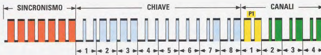
Fig.1 Il segnale generato dal trasmettitore è composto da un primo pacchetto di bit di sincronismo seguiti dagli 8 bit della chiave che consentono allo stadio ricevitore di identificare il trasmettitore. Da ultimo vengono trasmessi i 4 bit che indicano quale dei quattro pulsanti è stato premuto.
