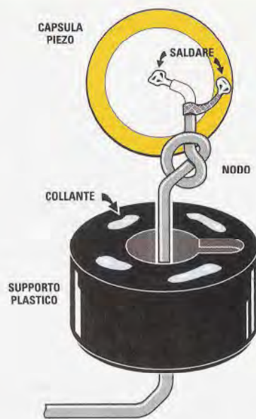
Fig.6 Per effettuare il montaggio del dischetto piezoelettrico sul supporto plastico occorre saldare il centrale del cavo schermato al centro del dischetto ceramico e la calza metallica al bordo esterno del dischetto. Completata la saldatura potrete procedere al fissaggio del dischetto sul supporto e per far questo potrete utilizzare un comune collante o in alternativa due strisce di nastro biadesivo.
