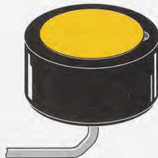
Fig.7 Fate quindi scorrere il cavo all'interno del foro centrale fino al bloccaggio del nodo, e appoggiate delicatamente il dischetto al supporto avendo cura che la calza metallica venga alloggiata correttamente nella scanalatura ricavata nel supporto plastico. In alternativa al bloccaggio tramite il nodo potrete utilizzare una comune fascetta plastica.
