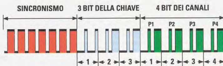
Fig.2 Il segnale codificato dal trasmettitore è formato dai 7 bit di sincronismo, seguiti dai 3 bit della chiave e dai 4 bit dei pulsanti. I bit della chiave vengono programmati tramite i ponticelli J1-J2-J3 posti sul trasmettitore e sul ricevitore.
